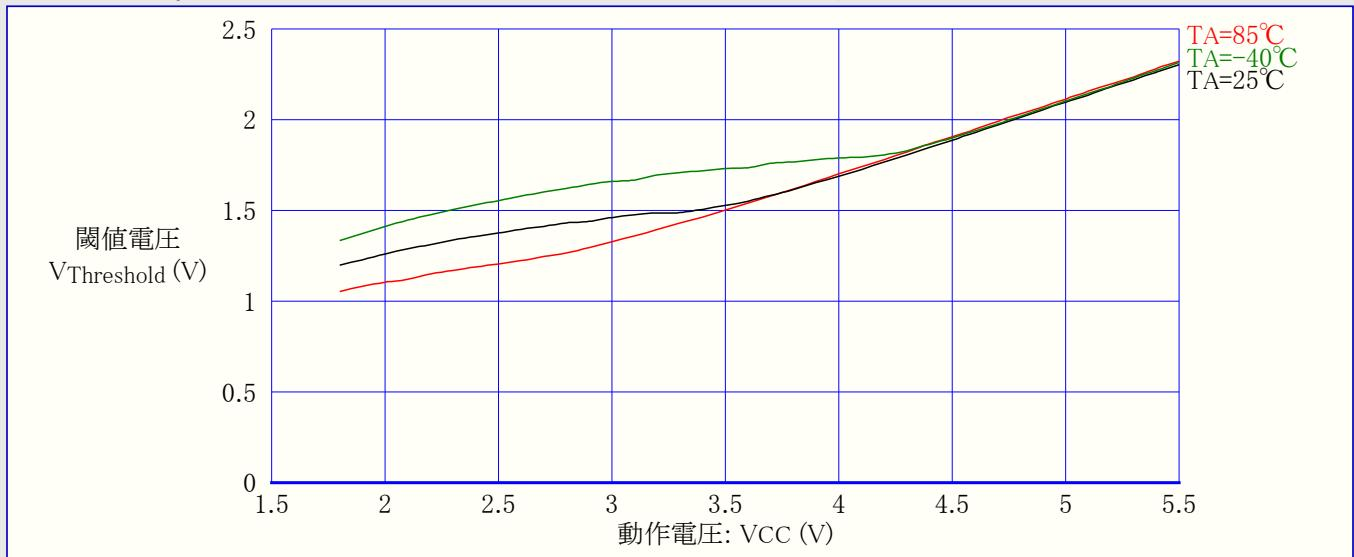
図21-47. ATtiny24A:RESET入力閾値(スレッショールト)電圧 対 動作電圧 (VIL,0読み値)
