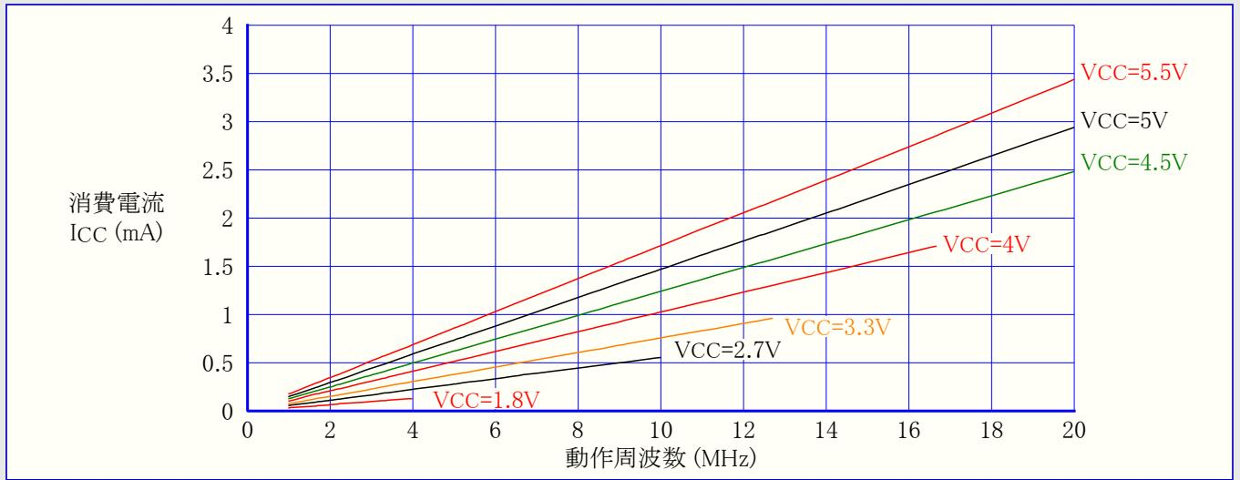
図21-63. ATtiny44A:アイドル動作消費電流 対 動作電圧 (内蔵RC発振器, 8MHz)
