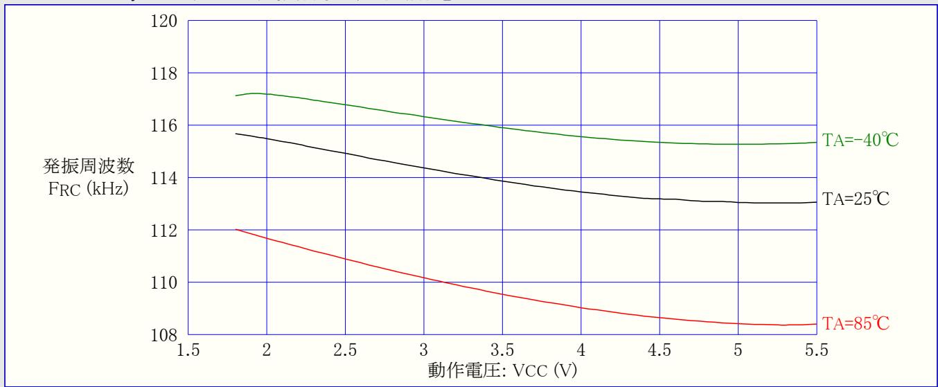
図21-161. ATtiny84A: ウオッチドッグ発振器周波数 対 動作温度
