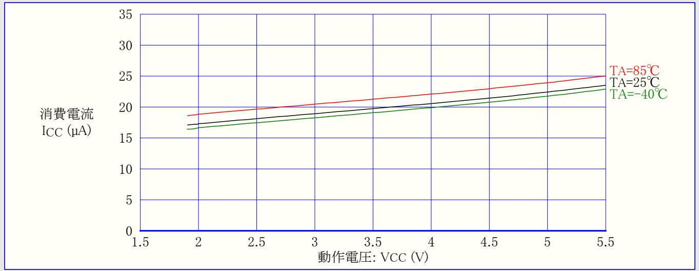
図21-76. ATtiny44A: ウオッチドッグ タイマ消費電流 対 動作電圧
