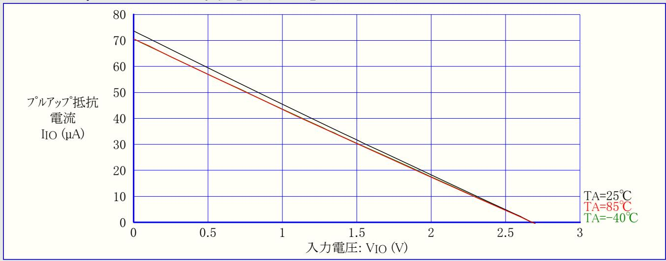
図21-79. ATtiny44A:I/Oピン フルアップ抵抗電流 対 入力電圧 (VCC=5V)
