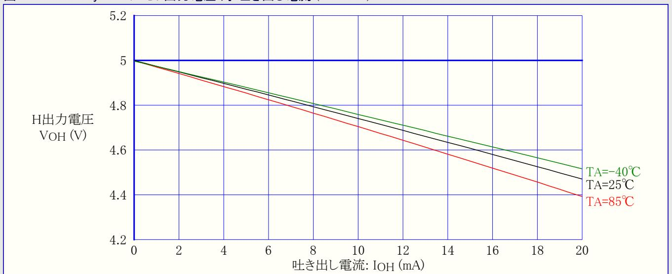
図21-141. ATtiny84A:RESETピン出力電圧 対 吸い込み電流 (VCC=3V)
