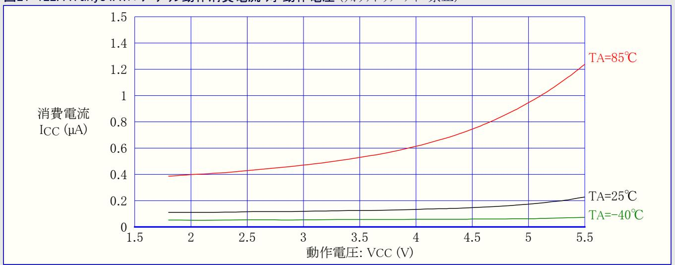
図21-123. ATtiny84A:パワーダウン動作消費電流 対 動作電圧 (ウォッチドッグタイマ許可)
