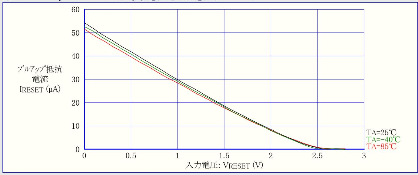
図21-136. ATTiny84A: RESETプルアップ抵抗電流 対 入力電圧 (VCC=5V)
