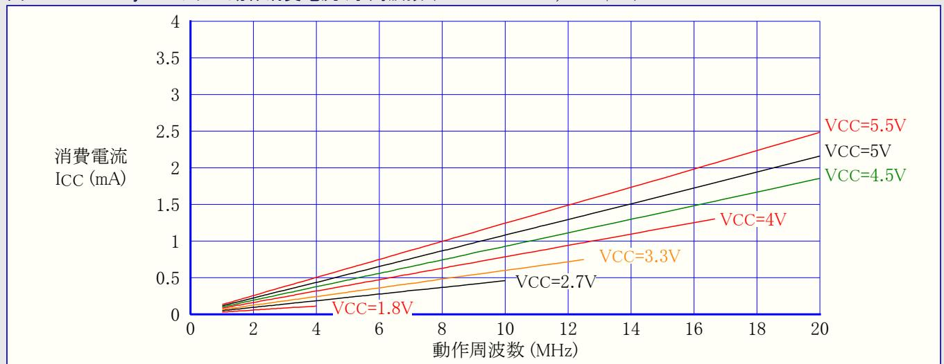
図21-119. ATtiny84A: アイドル動作消費電流 対 動作電圧 (内蔵RC発振器, 8MHz)
