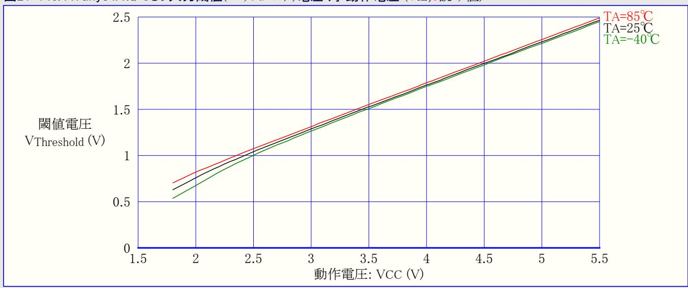
図21-147. ATtiny84A:I/Oピン入力ヒステリシス電圧 対 動作電圧
