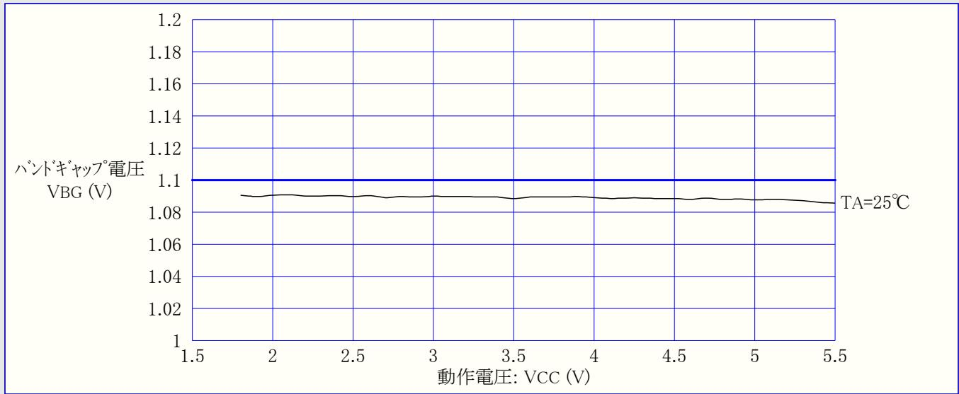
図21-45. ATtiny24A: 内部ハンドキャップ電圧 対 対 動作温度
