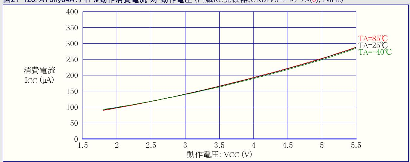
図21-121. ATtiny84A:アイドル動作消費電流 対 動作電圧 (内蔵WDT発振器, 128kHz)
