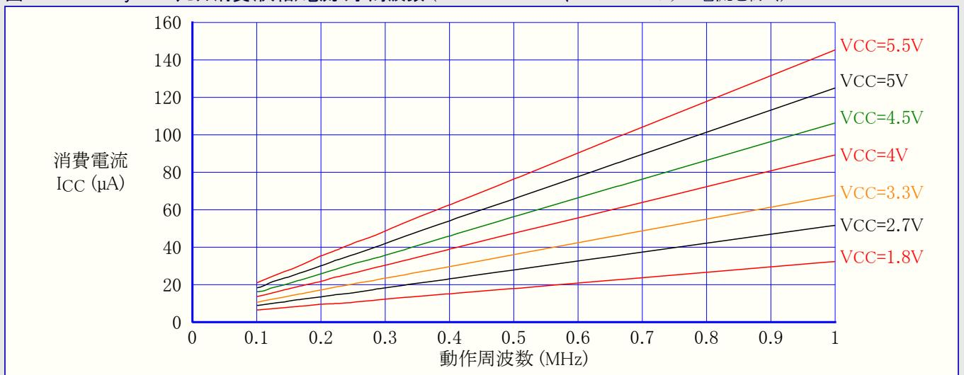
図21-70. ATtiny44A: リセット消費(供給)電流 対 周波数 (1MHz～20MHz、RESETプルアップ電流を除く)
