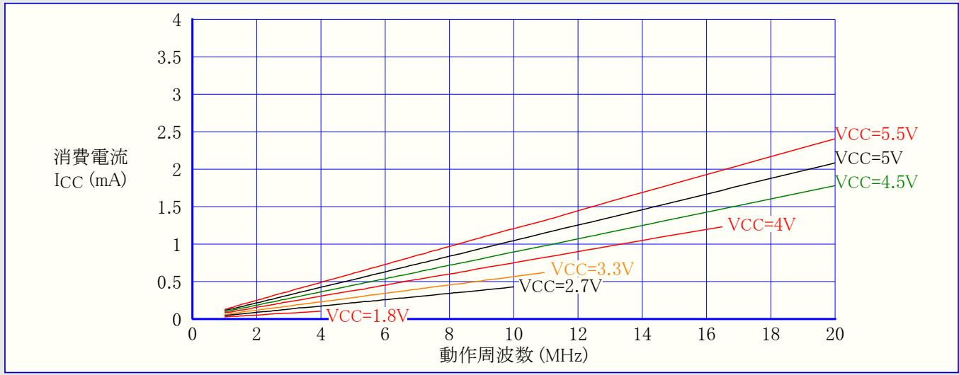
図21-8. ATtiny24A:アイドル動作消費電流 対 動作電圧 (内蔵RC発振器,8MHz)
