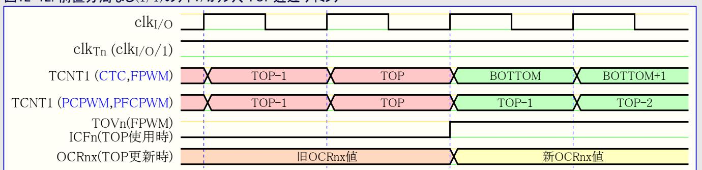
図12-13.は同じタイミングデータを示しますが、前置分周器が許可されています。
