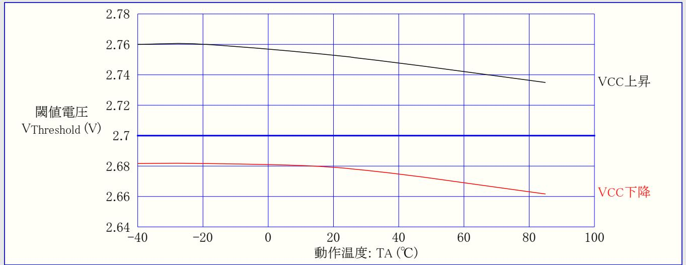
図21-99. ATtiny44A: 低電圧検出器(BOD)閾値(スレッショールド)電圧 対 動作温度 (検出電圧1.8V)
