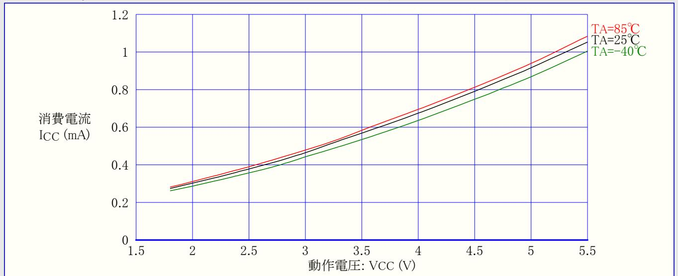
図21-5. ATtiny24A:活動動作消費電流 対 動作電圧 (内蔵WDT発振器,128kHz)
