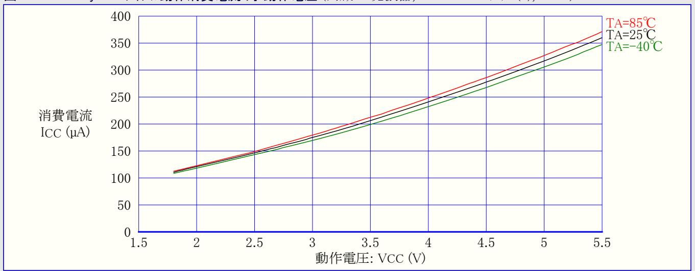
図21-65. ATtiny44A:アイドル動作消費電流 対 動作電圧 (内蔵WDT発振器,128kHz)
