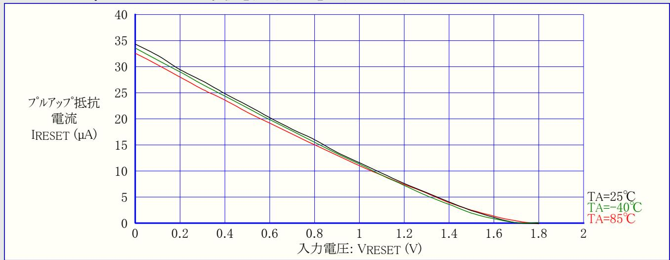
図21-135. ATtiny84A:RESET プルアップ抵抗電流 対 入力電圧 (VCC=2.7V)
