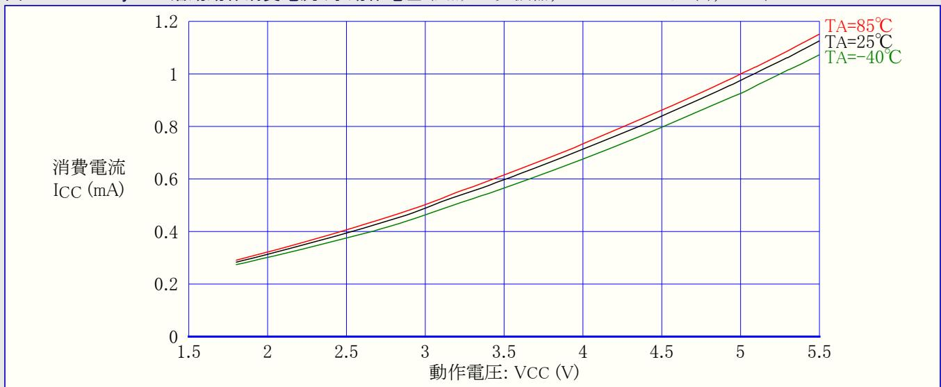
図21-60. ATtiny44A:活動動作消費電流 対 動作電圧 (内蔵WDT発振器,128kHz)
