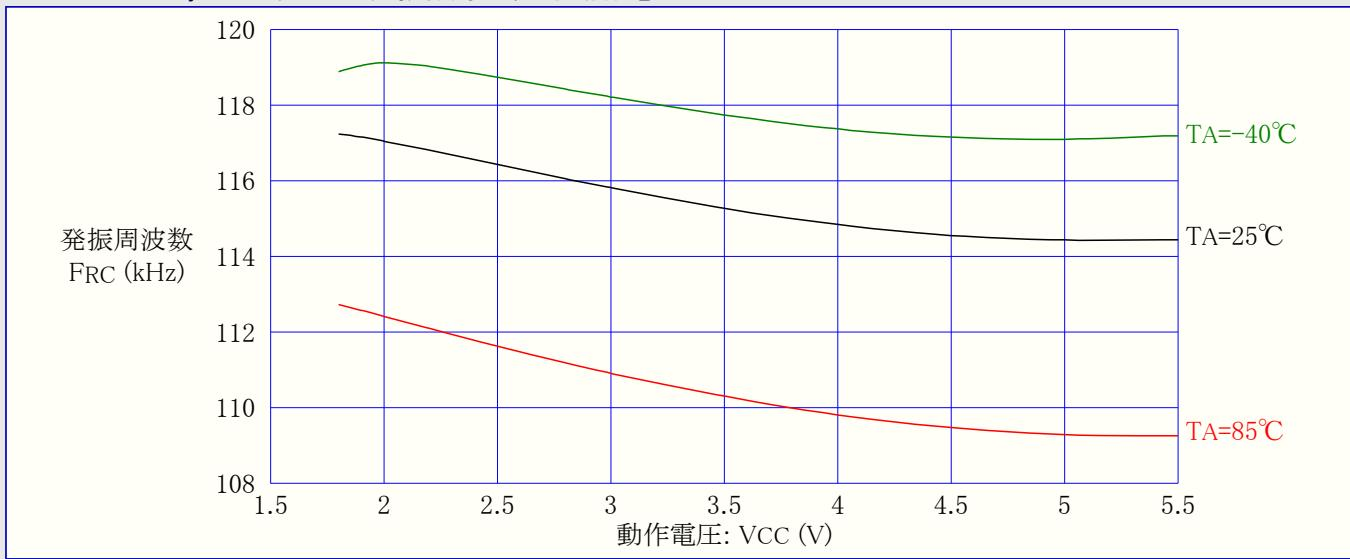
図21-108. ATtiny44A: ウオッチドッグ発振器周波数 対 動作温度
