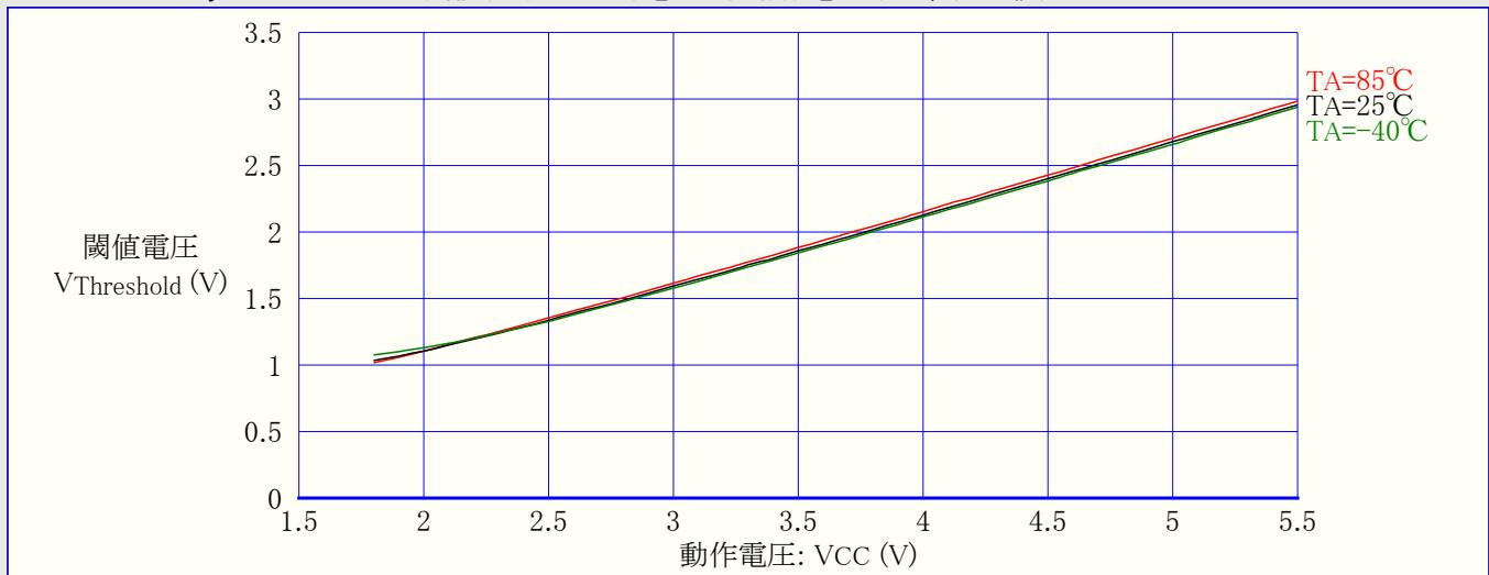
図21-146. ATtiny84A:I/Oピン入力閾値(スレッショールド)電圧 対 動作電圧 (VIL, 0読み値)
