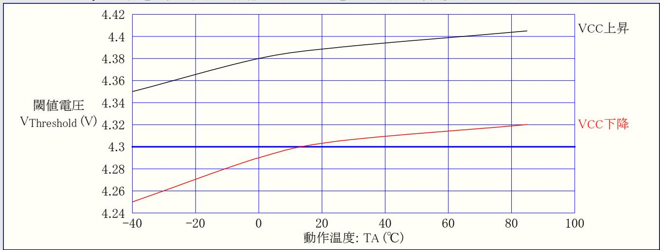
図21-152. ATtiny84A: 低電圧検出器(BOD)閾値(スレッショールド)電圧 対 動作温度 (検出電圧2.7V)
