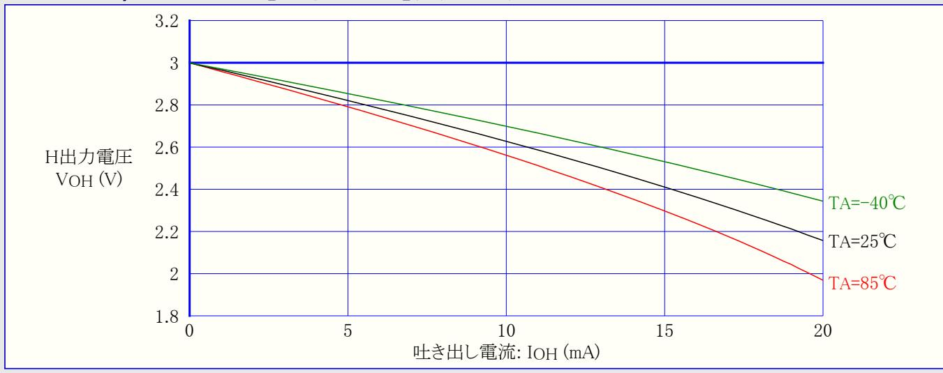
図21-86. ATtiny44A:I/Oピン出力電圧 対 吐き出し電流 (VCC=5V)
