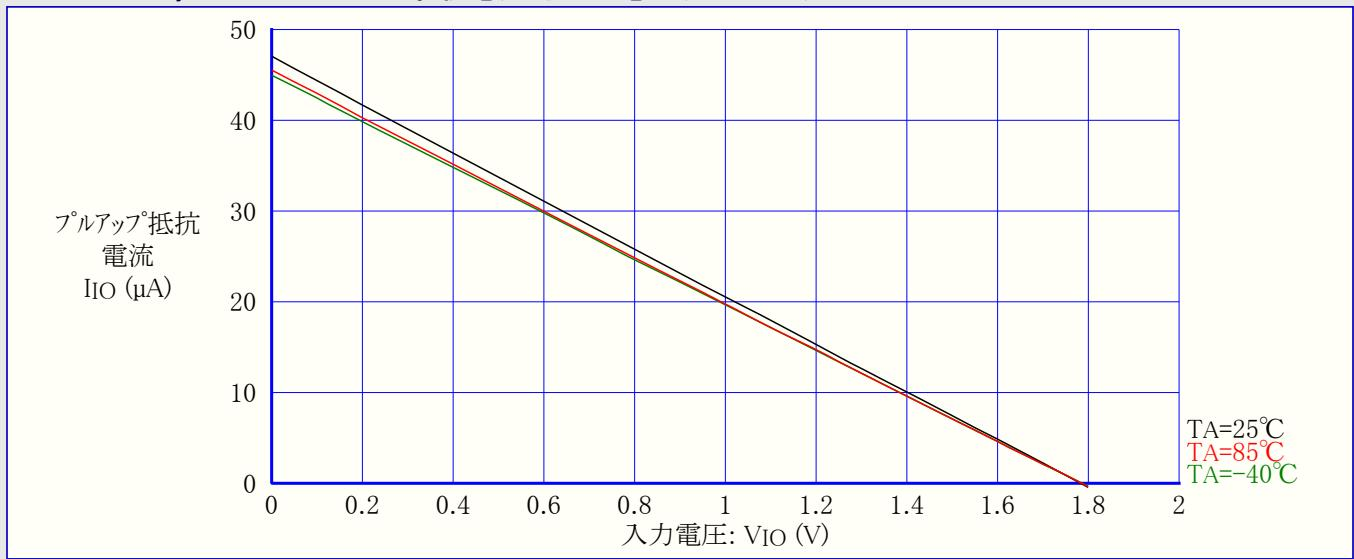
図21-78. ATtiny44A:I/Oピン フルアップ抵抗電流 対 入力電圧 (VCC=2.7V)
