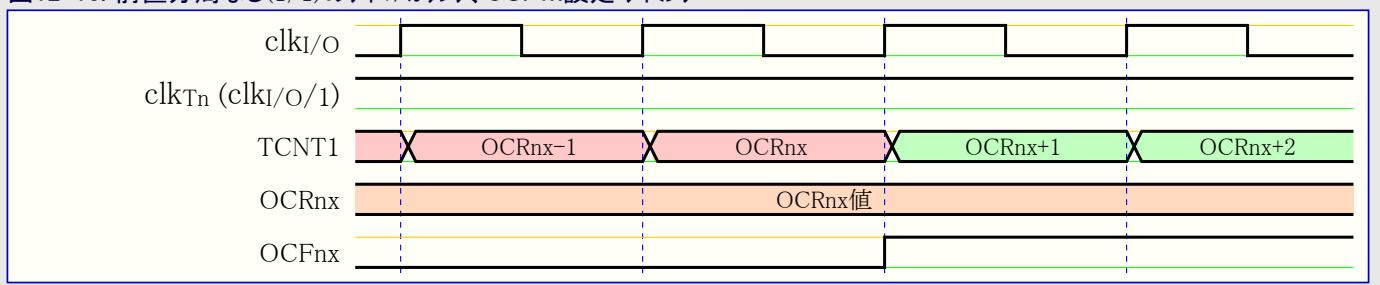
図12-11.は同じタイミングデータを示しますが、前置分周器が許可されています。
