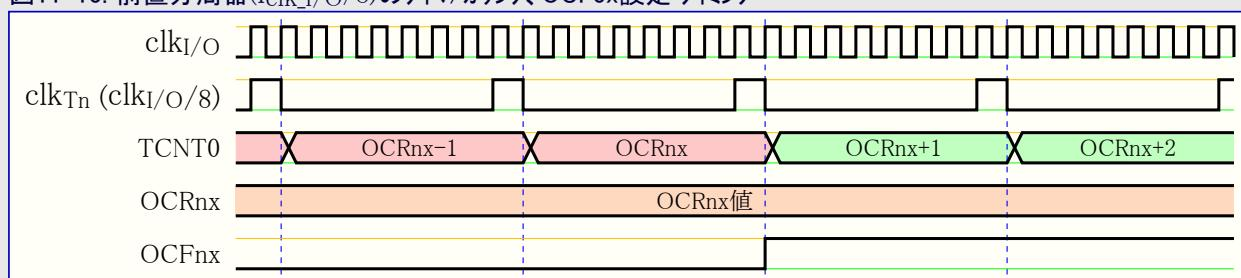
図11-11.はOCR0AがTOPの高速PWM動作と、CTC動作でのTCNT0の解除とOCF0Aの設定を示します。
