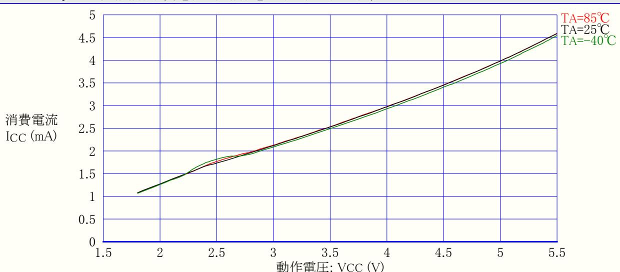
図21-115. ATtiny84A: 活動動作消費電流 対 動作電圧 (内蔵RC発振器, CKDIV8=プログラム(0), 1MHz)
