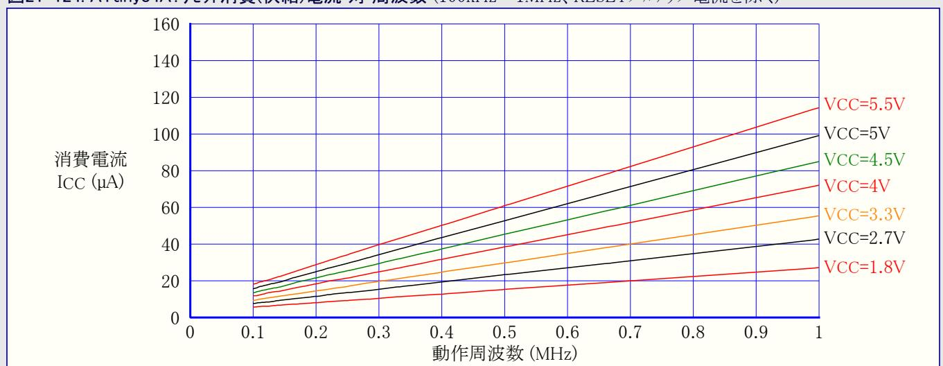
図21-125. ATtiny84A:リセット消費(供給)電流 対 周波数 (1MHz～20MHz、RESETプルアップ電流を除く)
