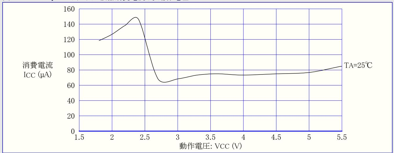
図21-18. ATtiny24A: プログラミング電流 対 動作電圧
