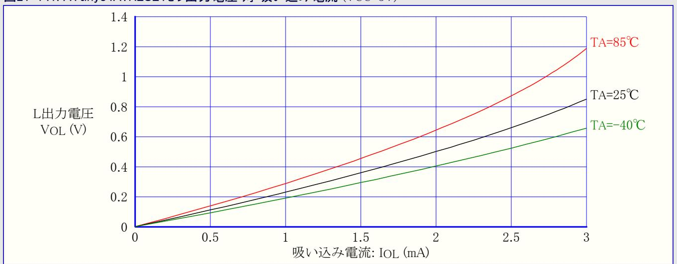
図21-142. ATtiny84A: RESETピン出力電圧 対 吸い込み電流 (VCC=5V)
