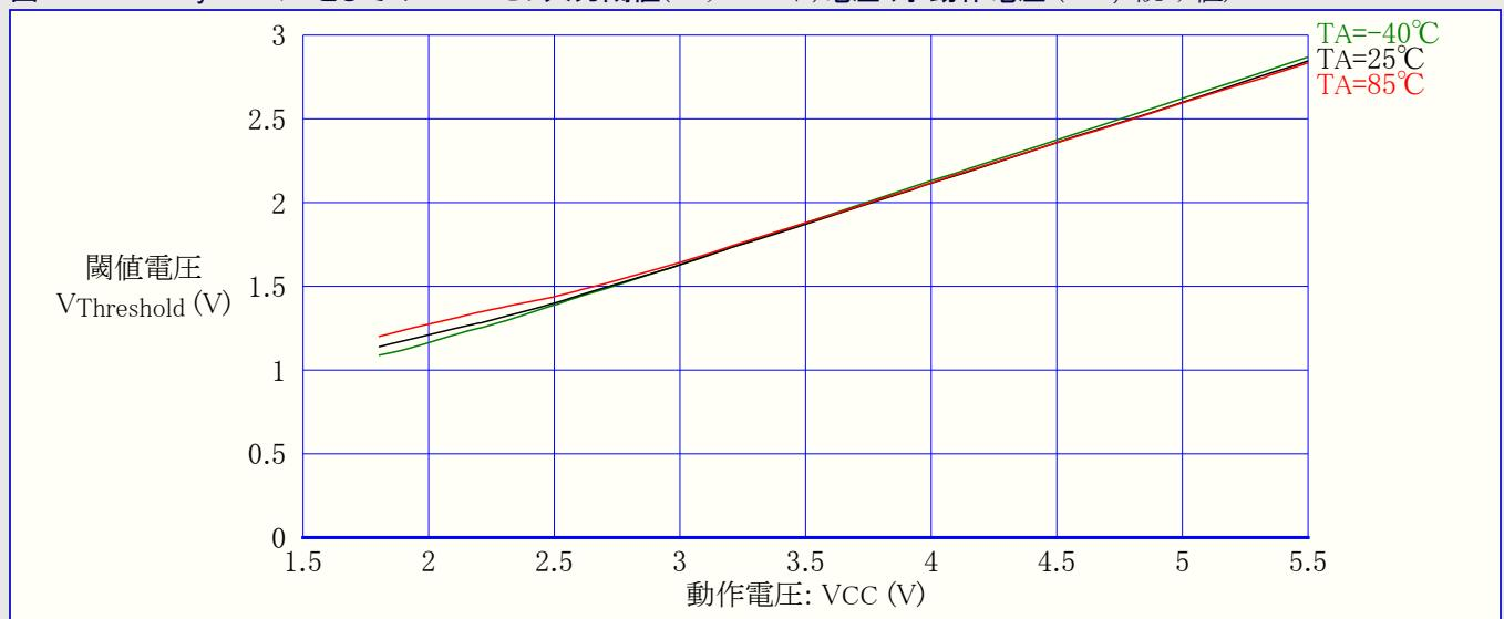
図21-95. ATtiny44A:I/OとしてのRESETピン入力閾値(スレッショールド)電圧 対 動作電圧 (VIL, 0読み値)
