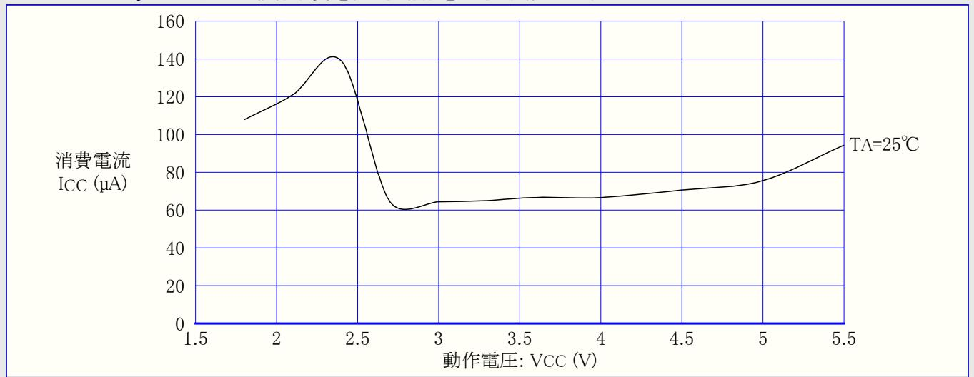
図21-129. ATtiny84A: プログラミング電流 対 動作電圧
