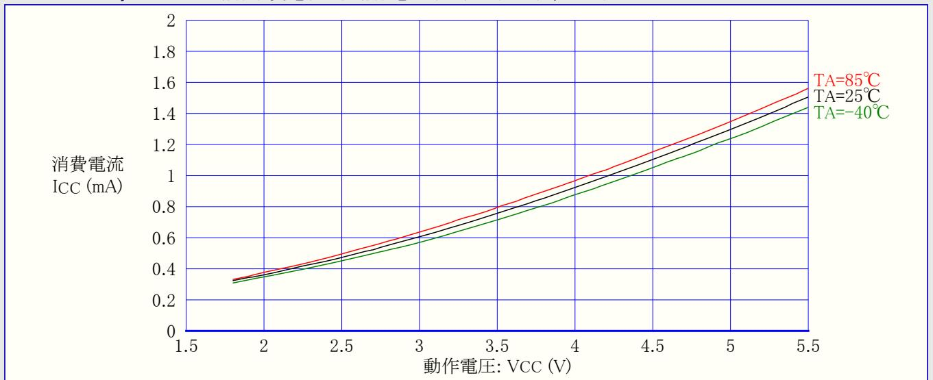
図21-64. ATtiny44A:アイドル動作消費電流 対 動作電圧 (内蔵RC発振器, CKDIV8=プログラム(0), 1MHz)
