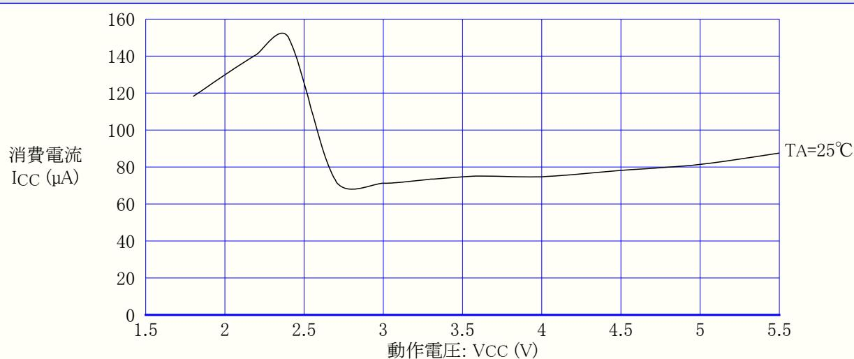
図21-74. ATtiny44A: プログラミング電流 対 動作電圧
