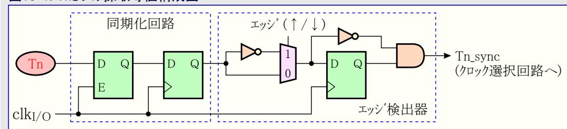
同期化とエッジ検出器論理回路はTnピンへ印加されたエッジから計数器が更新されるまでに2.5~3.5システムクロック周期の遅延をもたらします。
