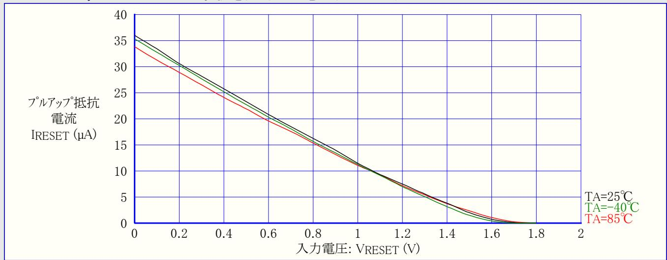
図21-25. ATtiny24A:RESET プルアップ抵抗電流 対 入力電圧 (VCC=2.7V)
