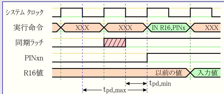
図10-4. プログラムで設定したピン値読み戻し時の同期化
