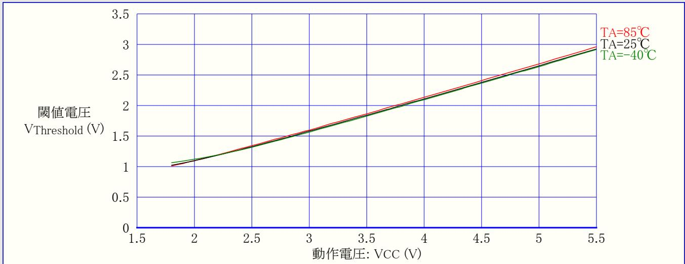
図21-36. ATtiny24A:I/Oピン入力閾値(スレッショールド)電圧 対 動作電圧 (VIL, 0読み値)
