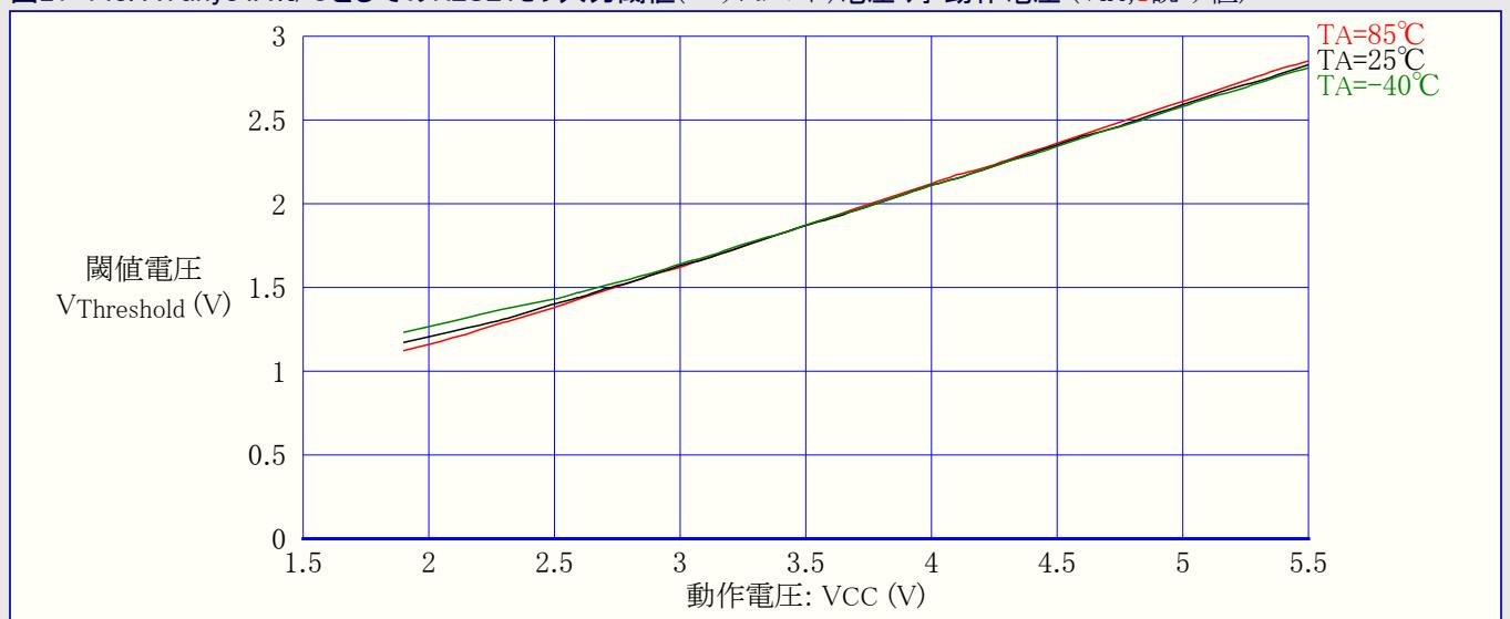
図21-149. ATtiny84A:I/OとしてのRESETピン入力閾値(スレッショールト)電圧 対 動作電圧 (VIL,0読み値)
