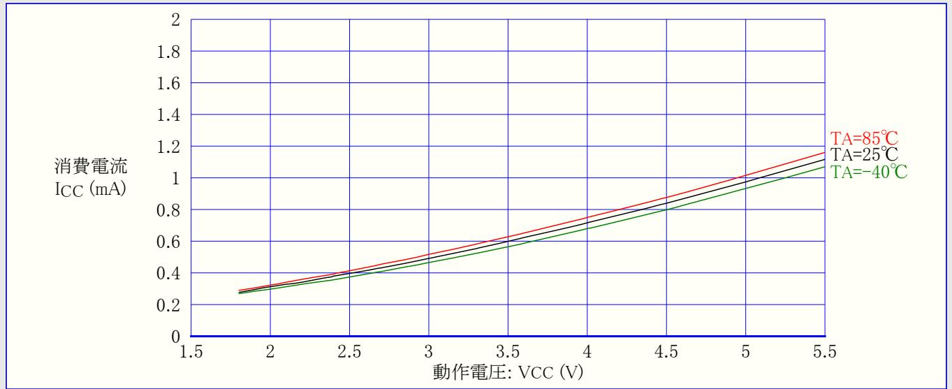
図21-9. ATtiny24A:アイドル動作消費電流 対 動作電圧 (内蔵RC発振器, CKDIV8=プログラム(0), 1MHz)
