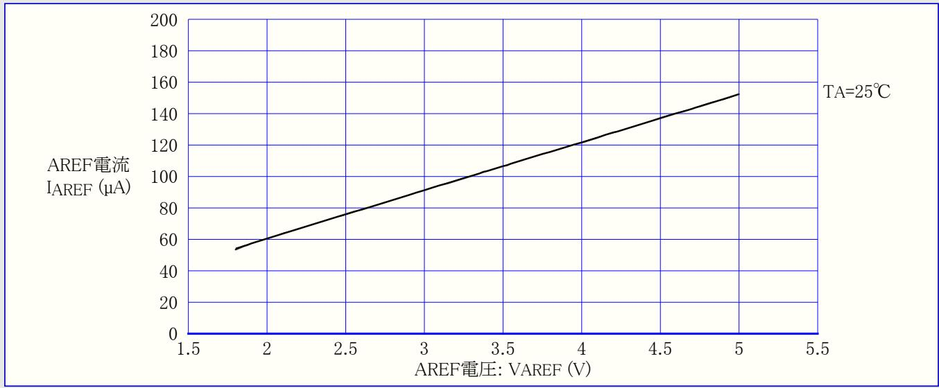
図21-17. ATtiny24A: アナログ比較器消費電流 対 動作電圧
