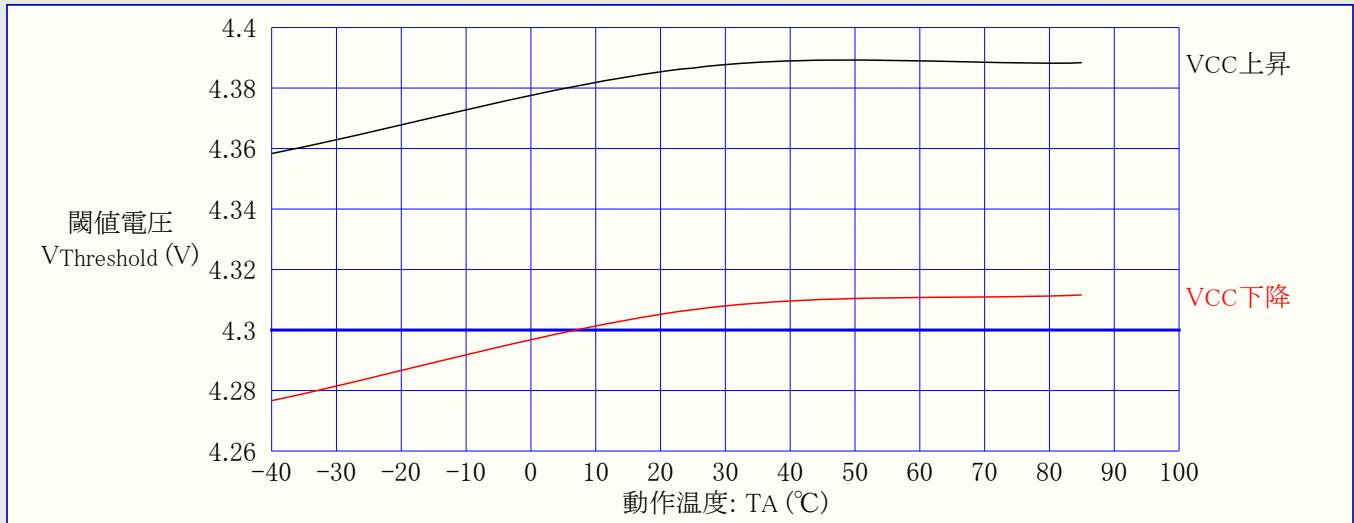
図21-42. ATTiny24A: 低電圧検出器(BOD)閾値(スレッショールト)電圧 対 動作温度 (検出電圧2.7V)
