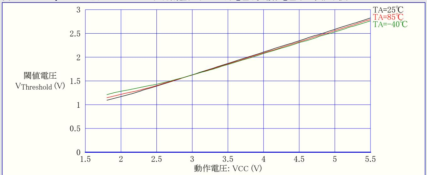
図21-39. ATtiny24A:I/OとしてのRESETピン入力閾値(スレッショールト)電圧 対 動作電圧 ( $V_{IL}$ , 0読み値)
