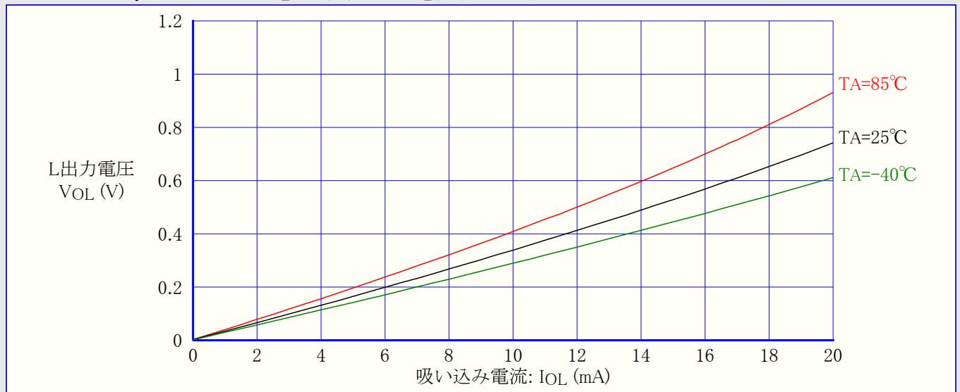
図21-138. ATTiny84A:I/Oピン出力電圧 対 吸い込み電流 (VCC=5V)
