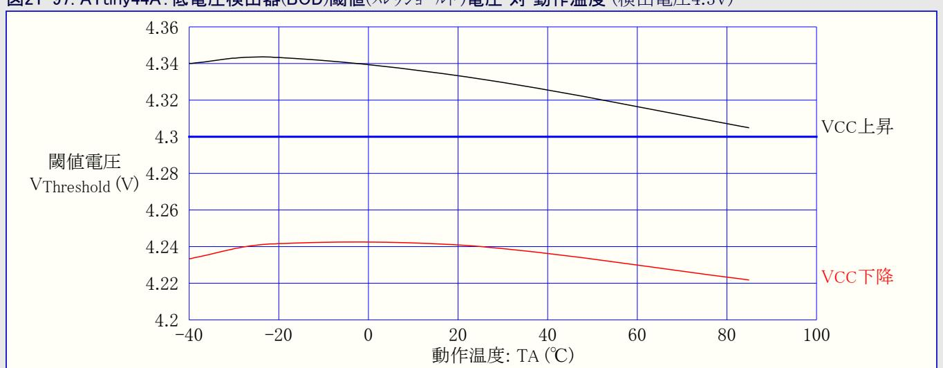
図21-98. ATtiny44A: 低電圧検出器(BOD)閾値(スレッショールド)電圧 対 動作温度 (検出電圧2.7V)
