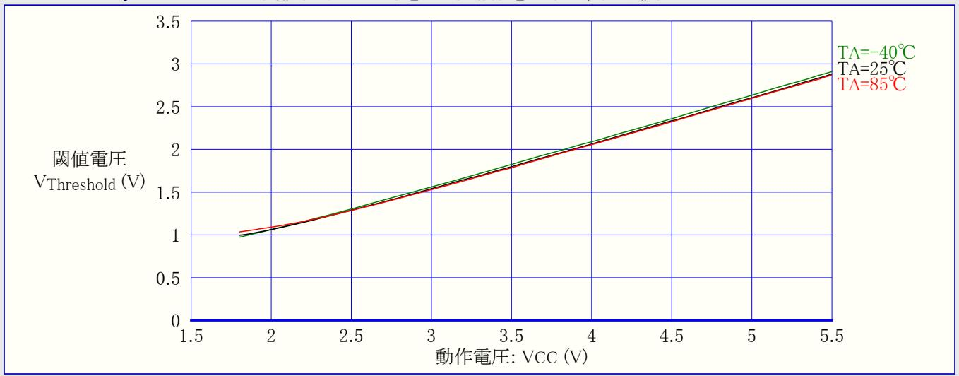
図21-92. ATtiny44A:I/Oピン入力閾値(スレッショールド)電圧 対 動作電圧 (VIL,0読み値)
