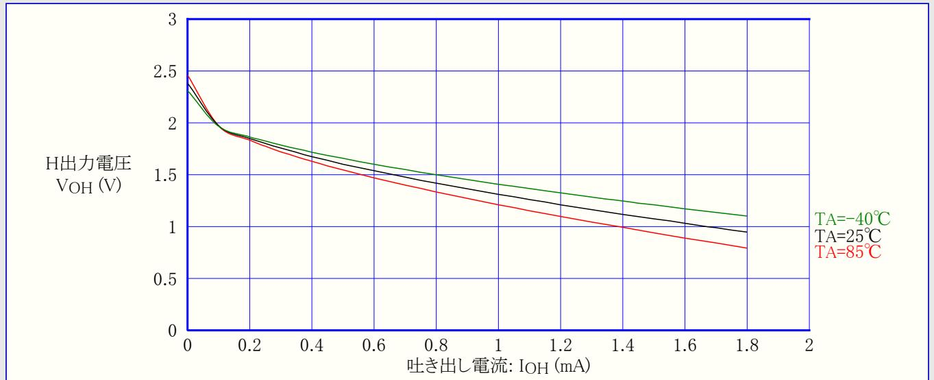
図21-34. ATtiny24A: RESETピン出力電圧 対 吐き出し電流 (VCC=5V)
