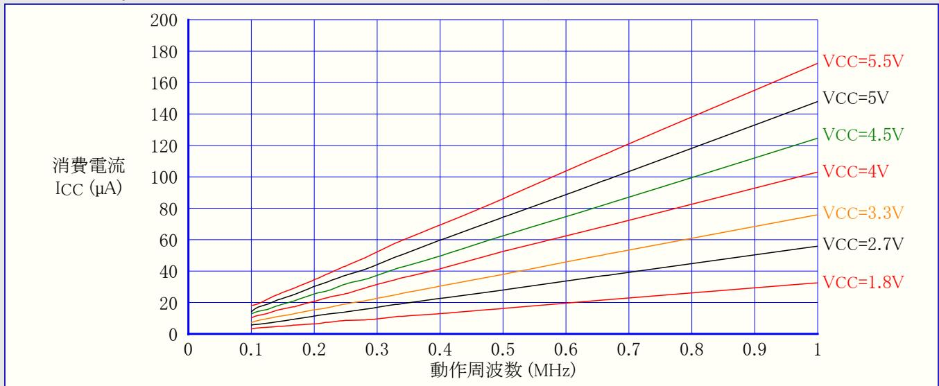
図21-62. ATtiny44A:アイドル動作消費電流 対 周波数 (1MHz～20MHz, PRR=\$FF)
