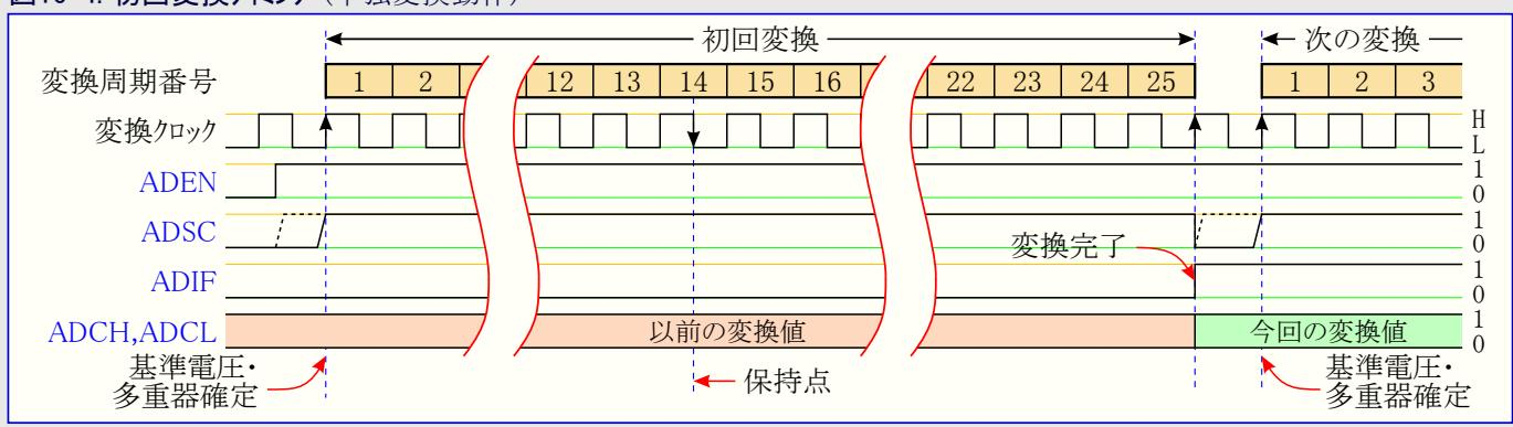
実際の採取&保持(保持開始点)は通常変換の開始後1.5変換クロック周期、初回変換の開始後13.5変換クロック周期で行われます。図16-5をご覧ください。変換が完了すると、結果がA/Dデータレジスタ(ADCH,ADCL)に書かれ、ADCSRAのA/D変換完了割り込み要求フラグ(ADIF)が設定(1)されます。単独変換動作(ADATE=0)では同時にADCSRAのA/D変換開始(ADSC)ビットが解除(0)されます。その後にソフトウェアは再びADSCを設定(1)でき、新規変換は変換クロックの最初の上昇端で開始されます。
