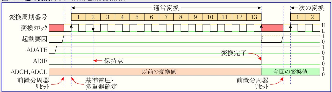
連続変換動作(ADATE=1)では変換完了後直ちに新規変換が開始され、一方ADSCは1に留まります。図16-7をご覧ください。
