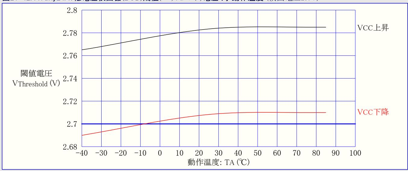
図21-43. ATTiny24A: 低電圧検出器(BOD)閾値(スレッショールト)電圧 対 動作温度 (検出電圧1.8V)
