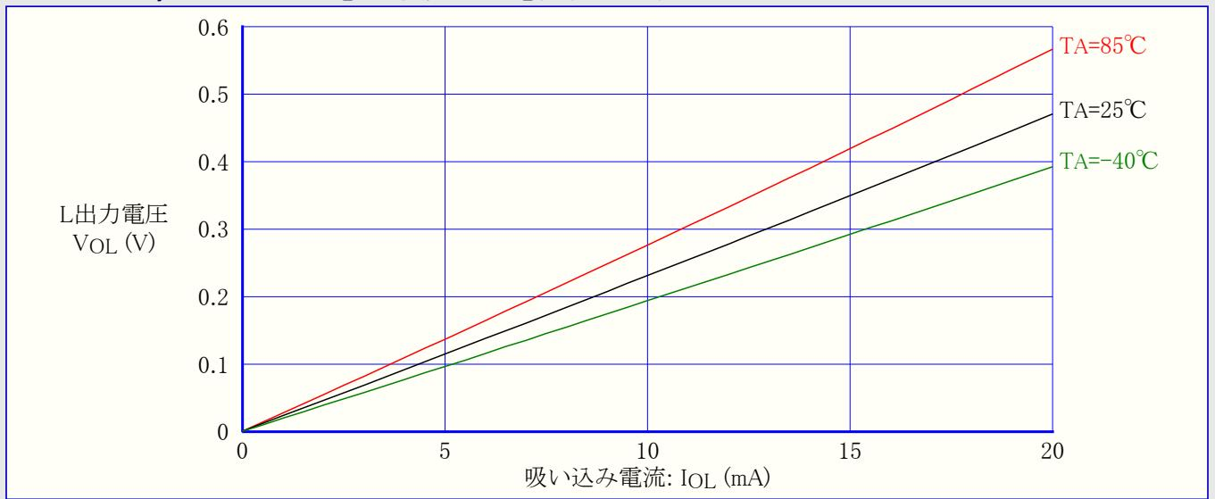
図21-29. ATtiny24A:I/Oピン出力電圧 対 吐き出し電流 (VCC=3V)
