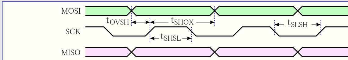
表20-11. 低電圧直列プログラミング特性 (特記条件を除いて、TA=-40°C~85°C, VCC=1.8~5.5V)
