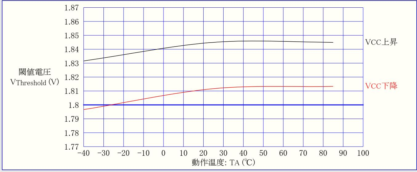
図21-44. ATtiny24A: 内部ハンドキャップ電圧 対 動作電圧
