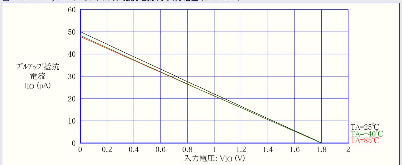
図21-22. ATtiny24A:I/Oピン プルアップ抵抗電流 対 入力電圧 (VCC=2.7V)
