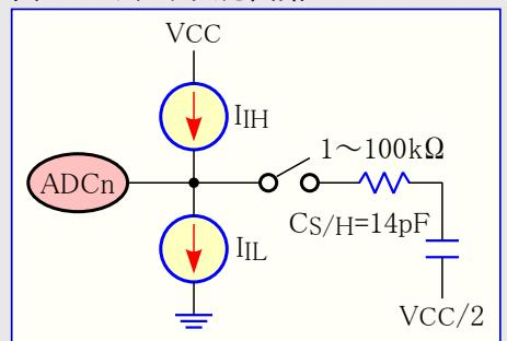
**注:** 図内のコンデンサ容量はS/Hコンデンサとデバイス内の何れかの浮遊容量または寄生容量を含む合計容量を叙述します。与えられた値は最悪(最大)値です。
