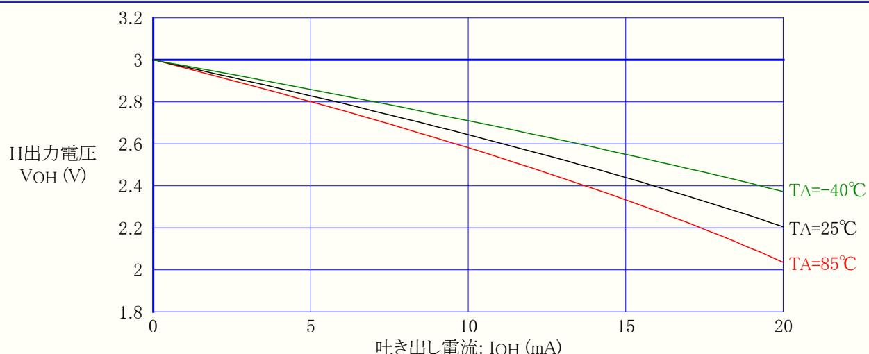
図21-30. ATtiny24A:I/Oピン出力電圧 対 吐き出し電流 (VCC=5V)
