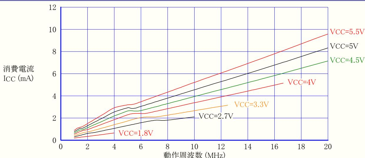
図21-114. ATtiny84A:活動動作消費電流 対 動作電圧 (内蔵RC発振器,8MHz)
