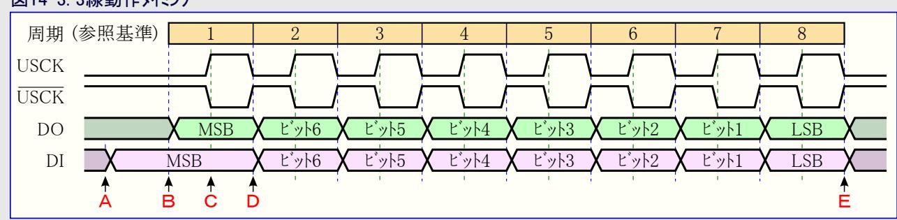
3線動作タイミングは図14-3で示されます。図の最上部はUSCK周期参照基準です。これらの各周期に対して1ビットが**USI移動レジスタ(USIDR)**に移動されます。USCKタイミングは両方の外部クロック動作について示されます。外部クロック動作0(USICS0=0)でのDIは上昇端で採取され、DOは下降端で変更(USIDRが1つ移動)されます。外部クロック動作1(USICS0=1)は外部クロック動作0に対して逆端を使用、換言すると下降端でデータが採取され、上昇端で出力が変更されます。USIクロック動作種別はSPIデータ動作種別0と1に対応します。
