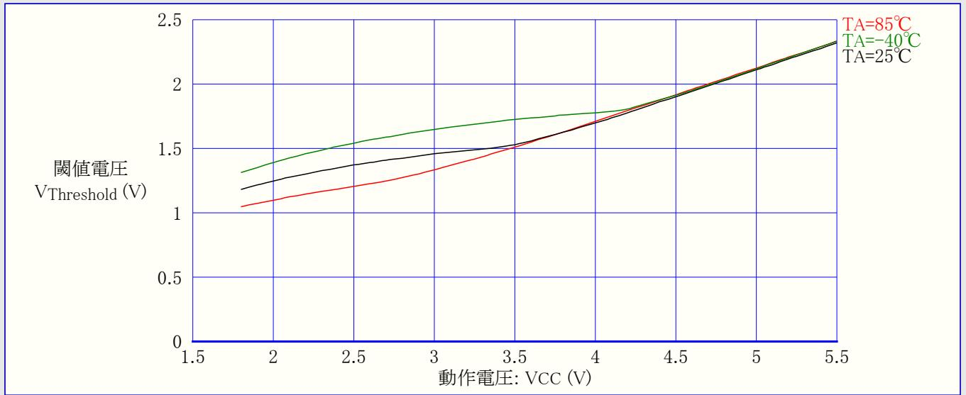
図21-156. ATtiny84A: RESET入力閾値(スレッショルド)電圧 対 動作電圧 (VIL, 0読み値)
