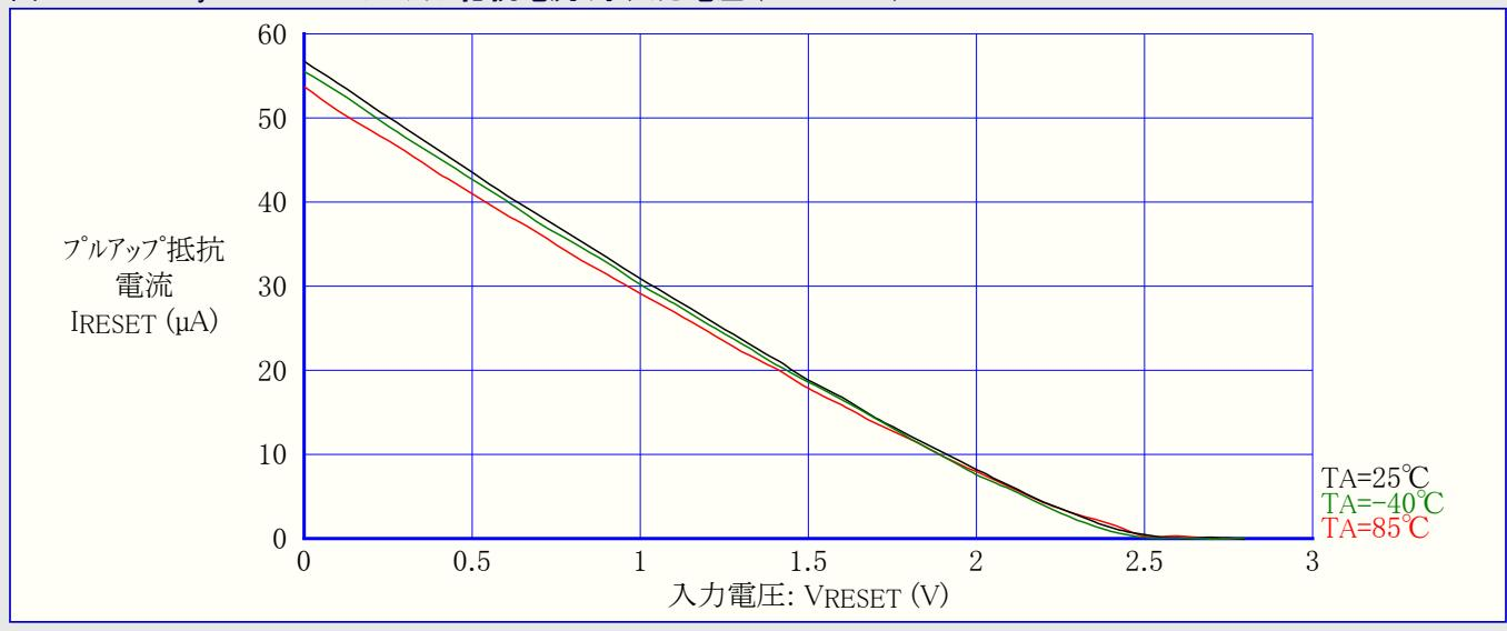
図21-26. ATtiny24A:RESETプルアップ抵抗電流 対 入力電圧 (VCC=5V)
