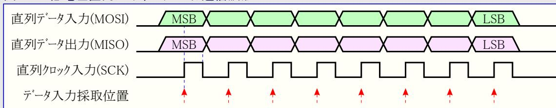
図20-4. 低電圧直列プログラミング タイミング
