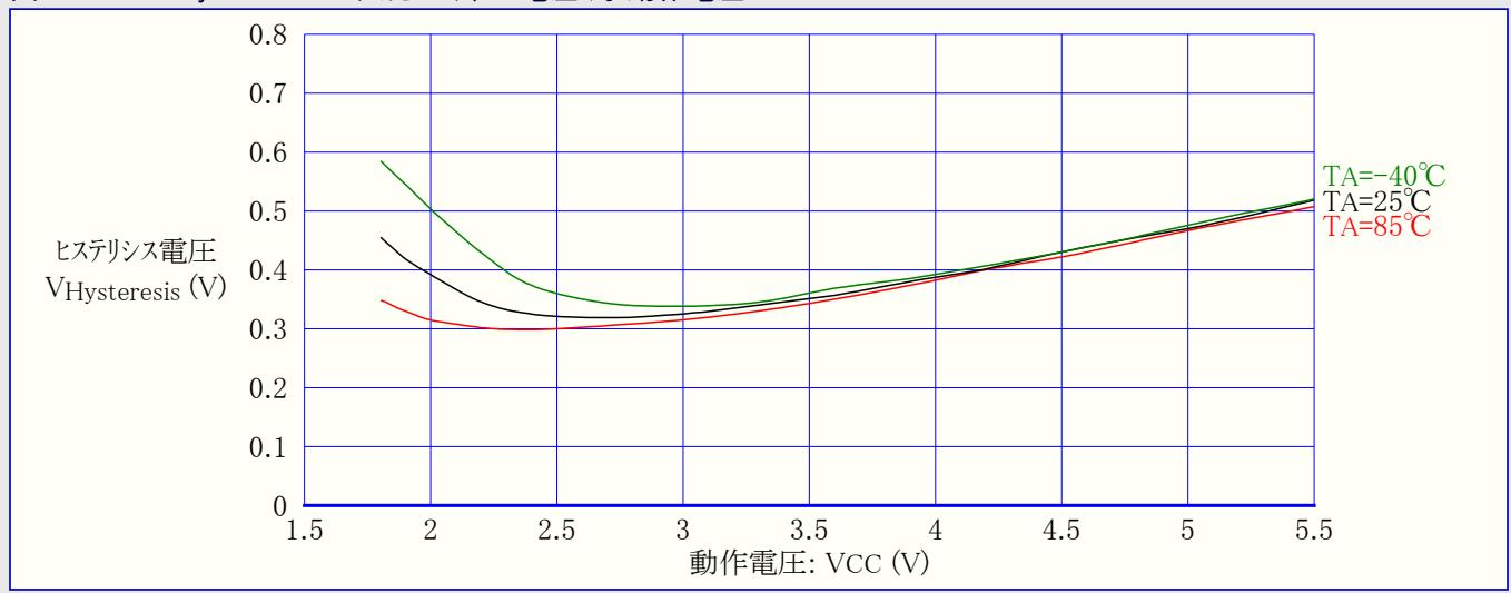
図21-94. ATtiny44A:I/OとしてのRESETピン入力閾値(スレッショールド)電圧 対 動作電圧 (VIH,1読み値)
