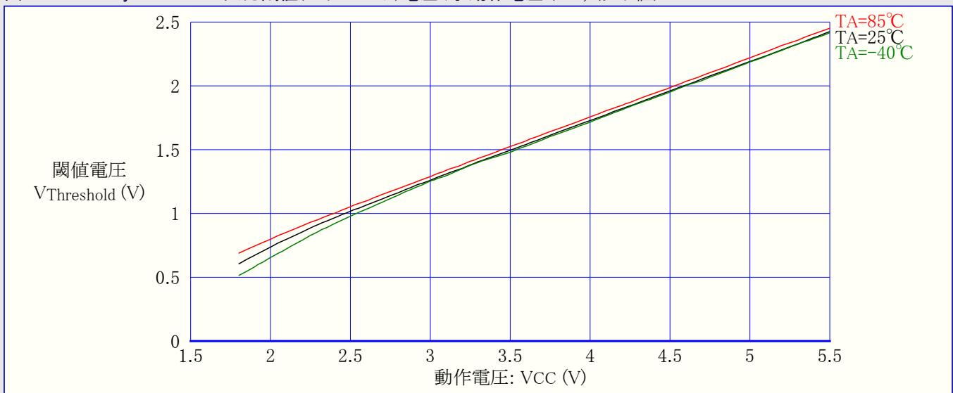
図21-37. ATtiny24A:I/Oピン入力ヒステリシス電圧 対 動作電圧
