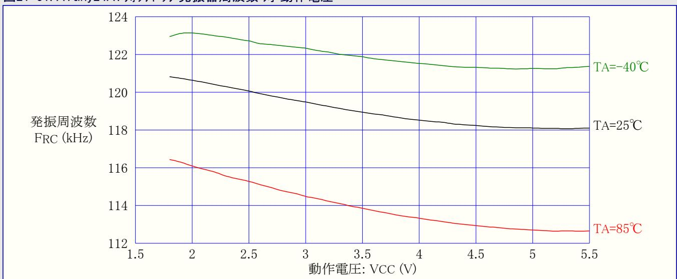
図21-52. ATtiny24A: ウオッチャップ発振器周波数 対 動作温度
