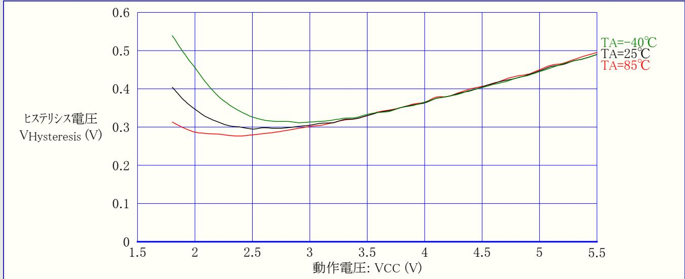
図21-148. ATtiny84A:I/OとしてのRESETピン入力閾値(スレッショールト)電圧 対 動作電圧 (VIH,1読み値)
