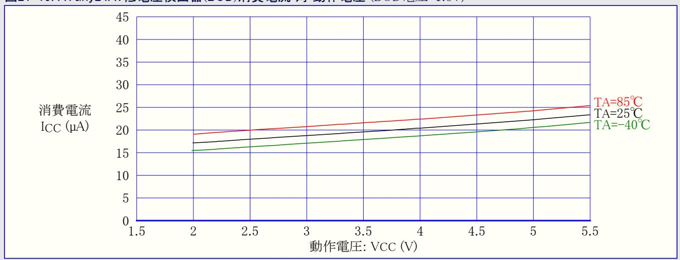
図21-20. ATtiny24A: ウオッチドッグ タイマ消費電流 対 動作電圧
