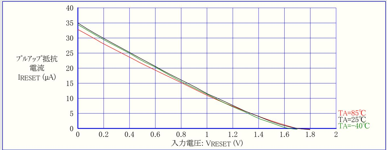
図21-81. ATtiny44A: RESETプルアップ抵抗電流 対 入力電圧 (VCC=2.7V)
