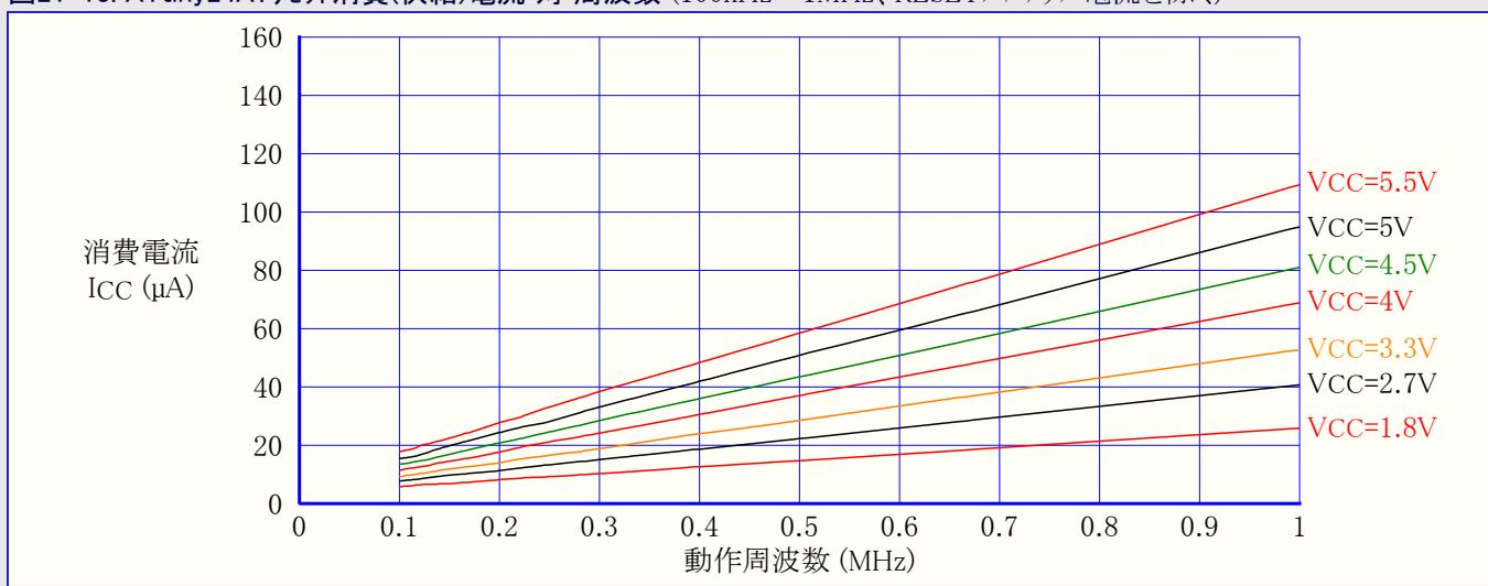
図21-14. ATtiny24A:リセット消費(供給)電流 対 周波数 (1MHz～20MHz、RESETプルアップ電流を除く)
