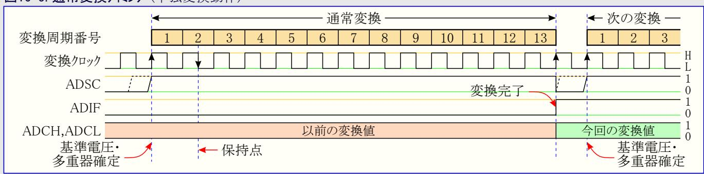
自動起動が使われる場合、下の図16-6で示されるように前置分周器は起動要因発生時にリセットされます。これは起動要因から変換開始までの一定の遅延を保証します。この動作での採取&保持は起動要因となる信号の上昇後、2変換クロック周期で採取が行われます。同期化論理回路(エッジ検出器)に対して追加の3CPUクロック周期が費やされます。
