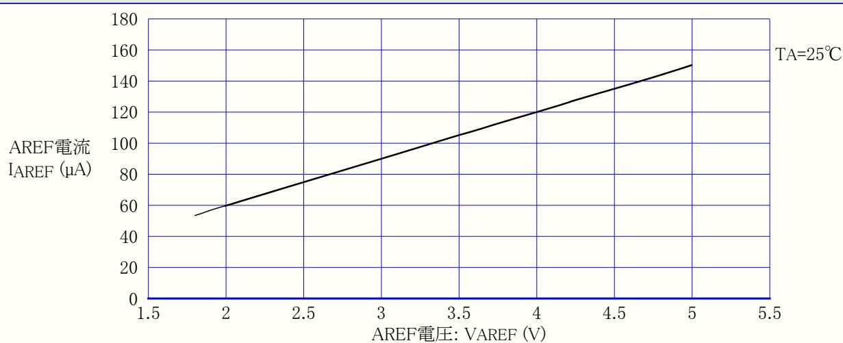
図21-73. ATtiny44A:アナログ比較器消費電流 対 動作電圧
