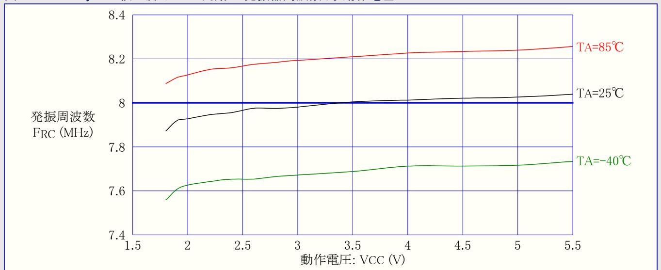
図21-54. ATtiny24A:校正済み8MHz内蔵RC発振器周波数 対 動作温度
