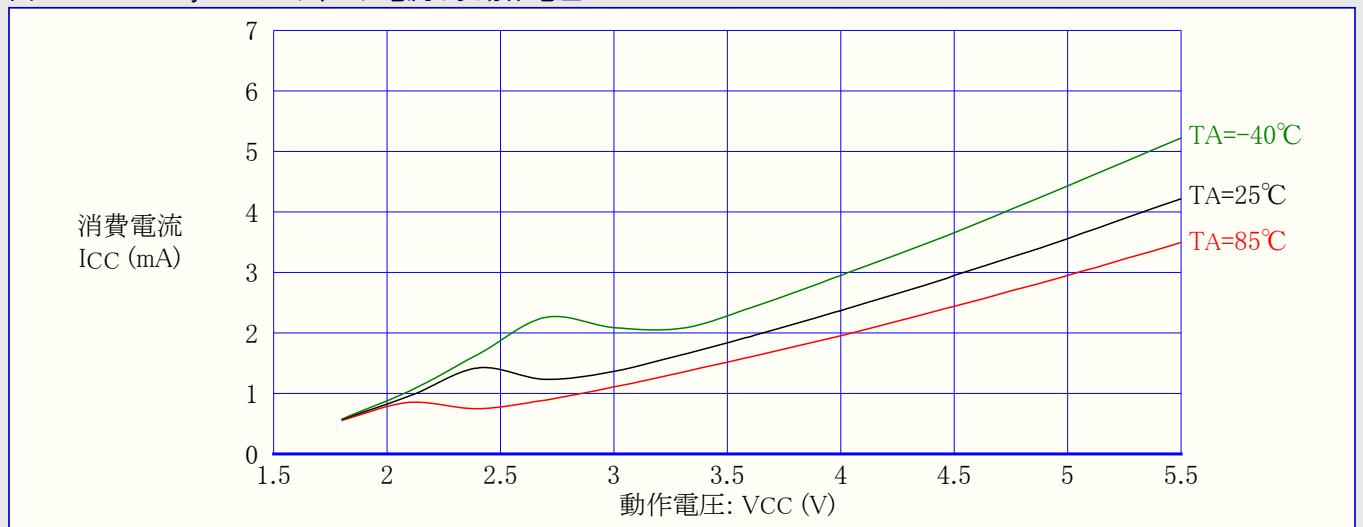
図21-130. ATtiny84A:低電圧検出器(BOD)消費電流 対 動作電圧 (BOD電圧=1.8V)
