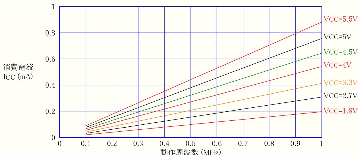
図21-113. ATtiny84A:活動動作消費電流 対 周波数 (1MHz～20MHz,PRR=\$FF)
