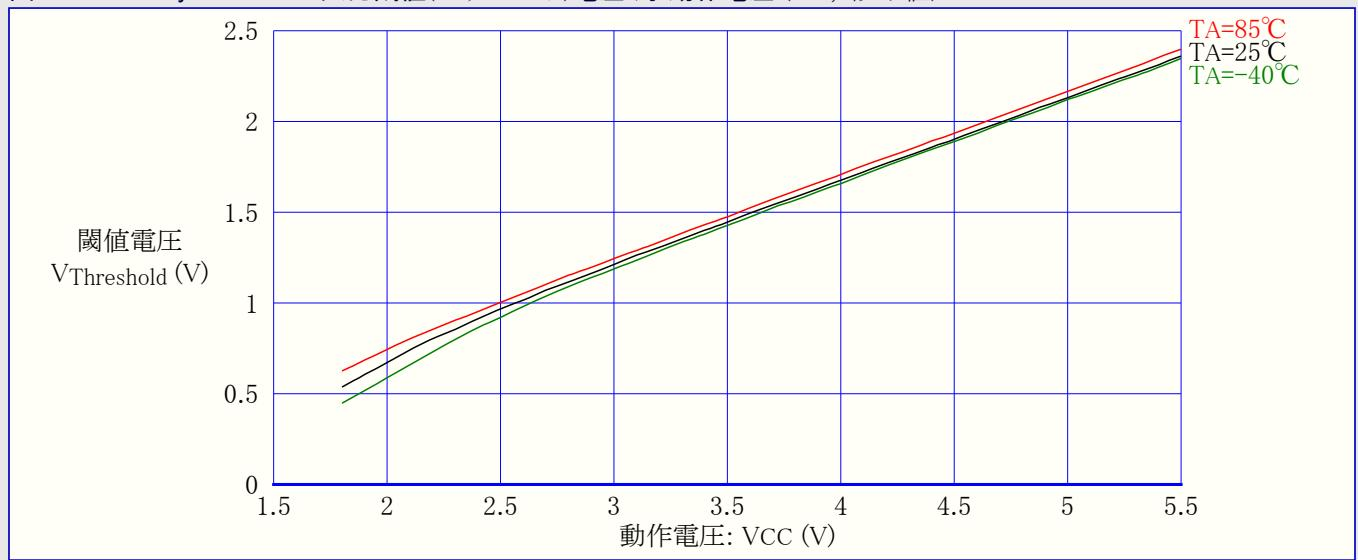
図21-93. ATtiny44A:I/Oピン入力ヒステリシス電圧 対 動作電圧
