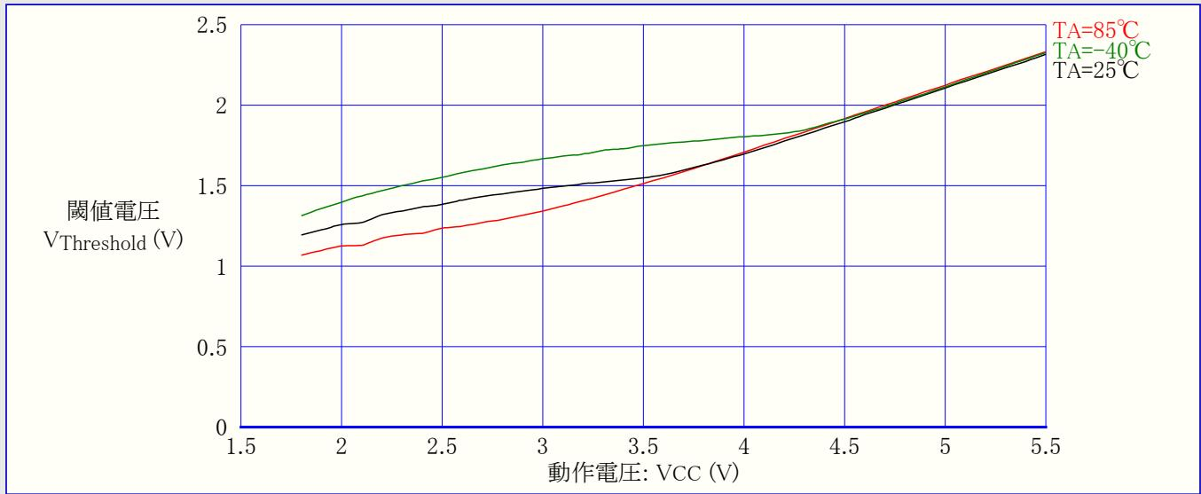
図21-103. ATtiny44A: RESET入力閾値(スレッショルド)電圧 対 動作電圧 (VIL, 0読み値)
