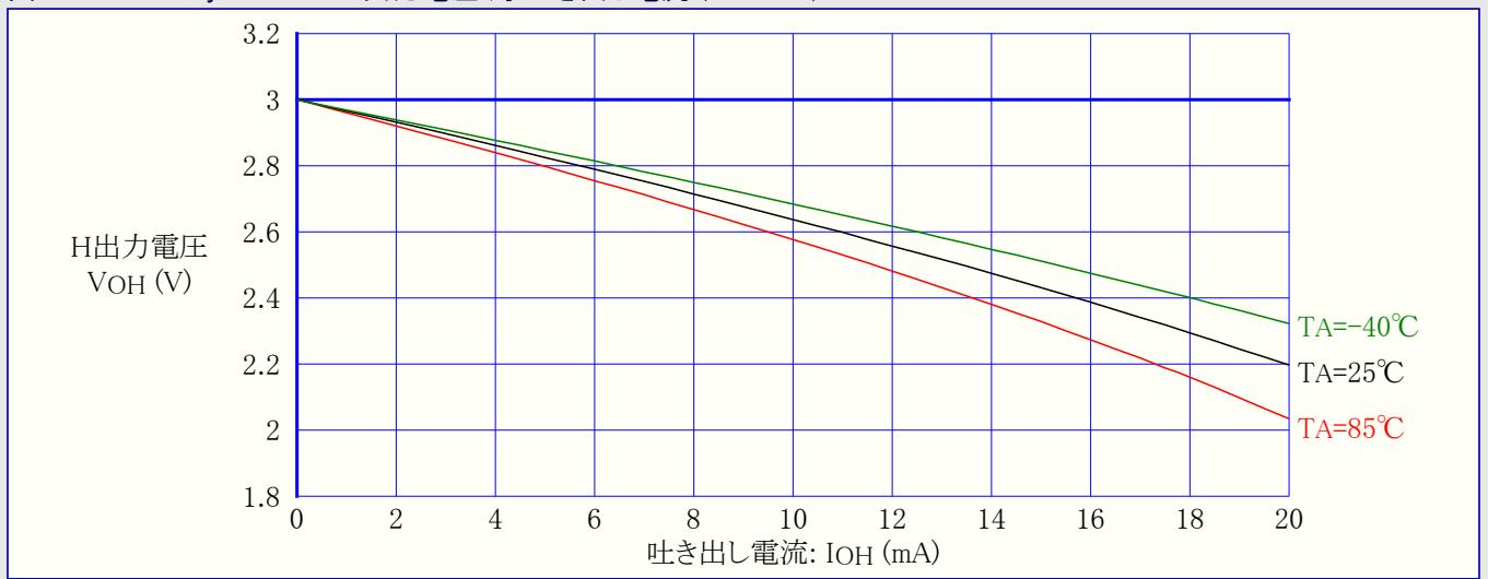
図21-140. ATtiny84A:I/Oピン出力電圧 対 吐き出し電流 (VCC=5V)
