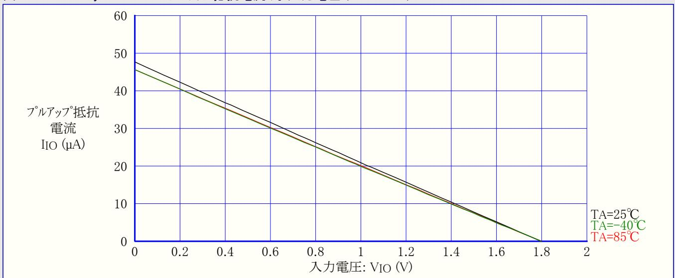
図21-132. ATtiny84A:I/Oピン プルアップ抵抗電流 対 入力電圧 (VCC=2.7V)
