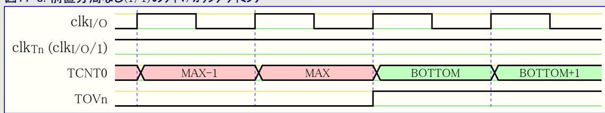
図11-9.は同じタイミングデータを示しますが、前置分周器が許可されています。
