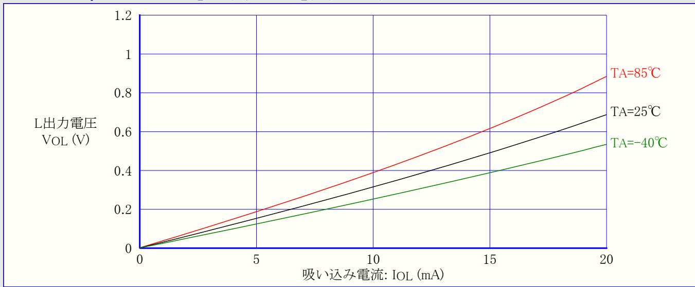
図21-84. ATtiny44A:I/Oピン出力電圧 対 吸い込み電流 (VCC=5V)
