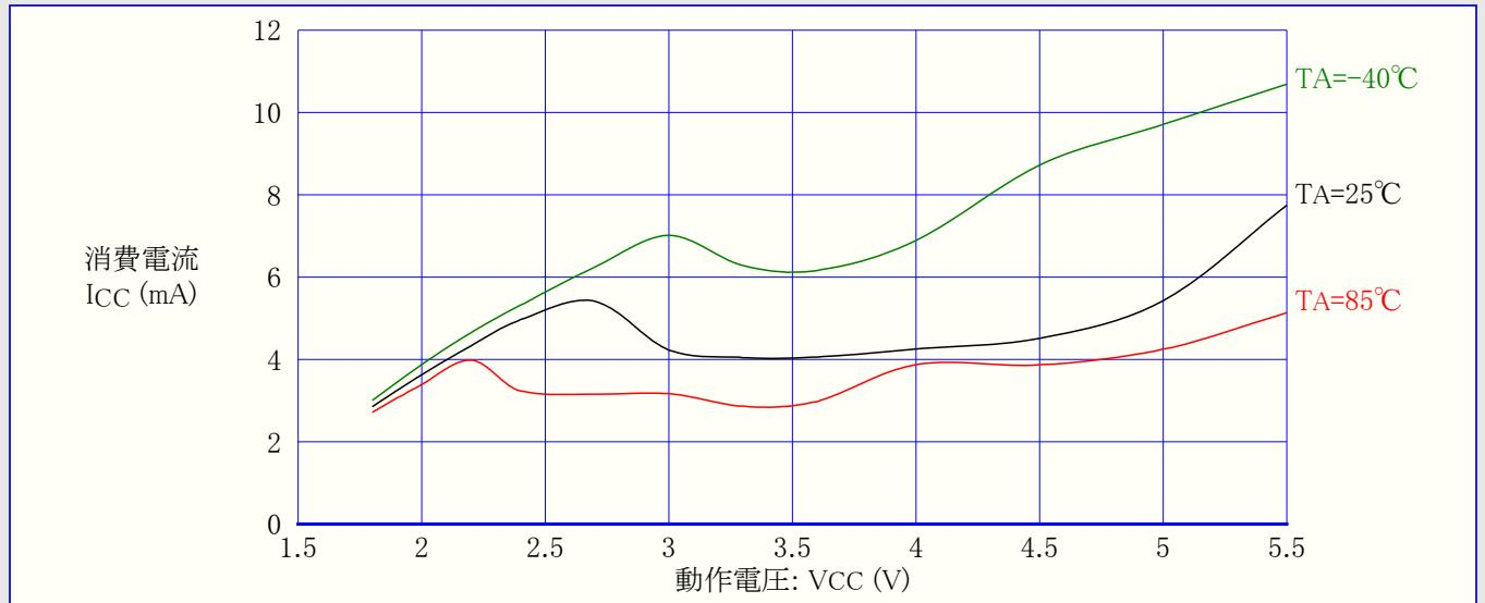
図21-75. ATtiny44A: 低電圧検出器(BOD)消費電流 対 動作電圧 (BOD電圧=1.8V)
