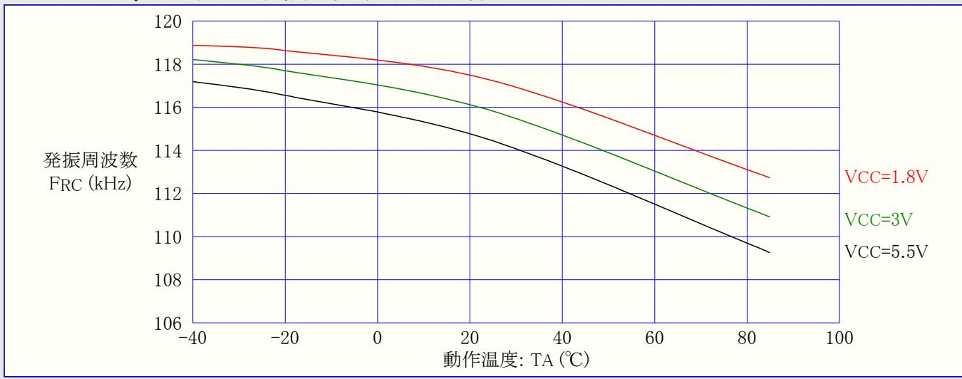
図21-109. ATtiny44A: 校正済み8MHz内蔵RC発振器周波数 対 動作電圧
