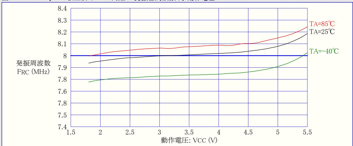
図21-163. ATtiny84A: 校正済み8MHz内蔵RC発振器周波数 対 動作温度
